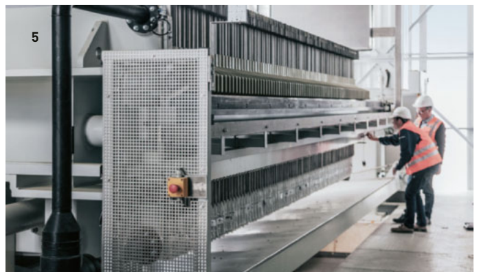
1 Filtres à bande sous vide / 2 Installations de traitement des boues, travaux de bétonnage sous-terrain, Stuttgart 21 / 3 Crible rotatif, tunnel Katzenberg / 4 Station de préparation et dosage de flocculant / 5 Filtre-presse automatisée
