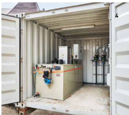
1 Filtres à bande sous vide / 2 Installations de traitement des boues, travaux de bétonnage sous-terrain, Stuttgart 21 / 3 Crible rotatif, tunnel Katzenberg / 4 Station de préparation et dosage de flocculant / 5 Filtre-presse automatisée
