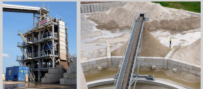
Abb. 4: PFAS TerraPure®: Waschturms für PFAS-haltige Böden (links), tägliche Produktion von bis zu 2.000 t an gereinigtem Sand (rechts).
