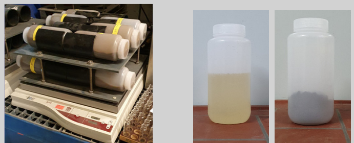
Abb. 6: Laborversuch PFAS-Bodenwäsche (li.), Eluat (Mitte), Boden (re.)
