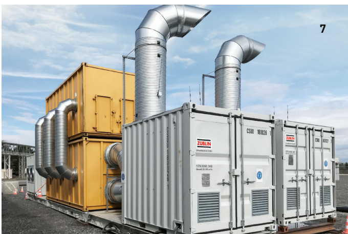
5 Mobile Tankabsauganlage/ 6 Abluftreinigung für hochbelastete Hallenluft/ 7 Abluftreinigungsanlage/ 8 Hallenbewetterung mit Abluftreinigung
