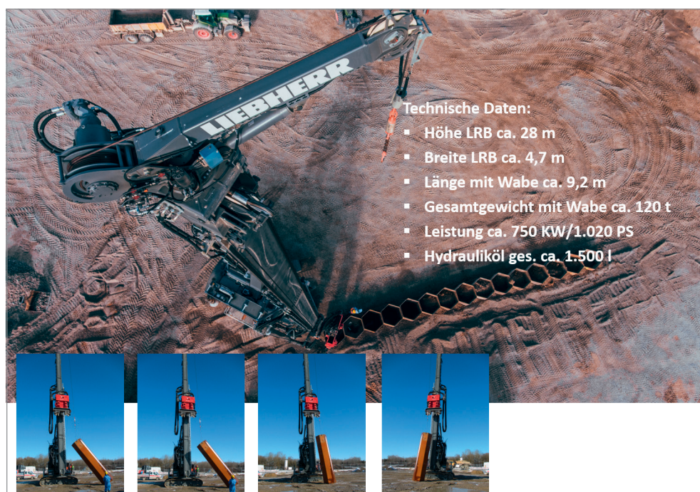
Abbildung 3: Ramm- und Bohrgerät mit technischen Daten
