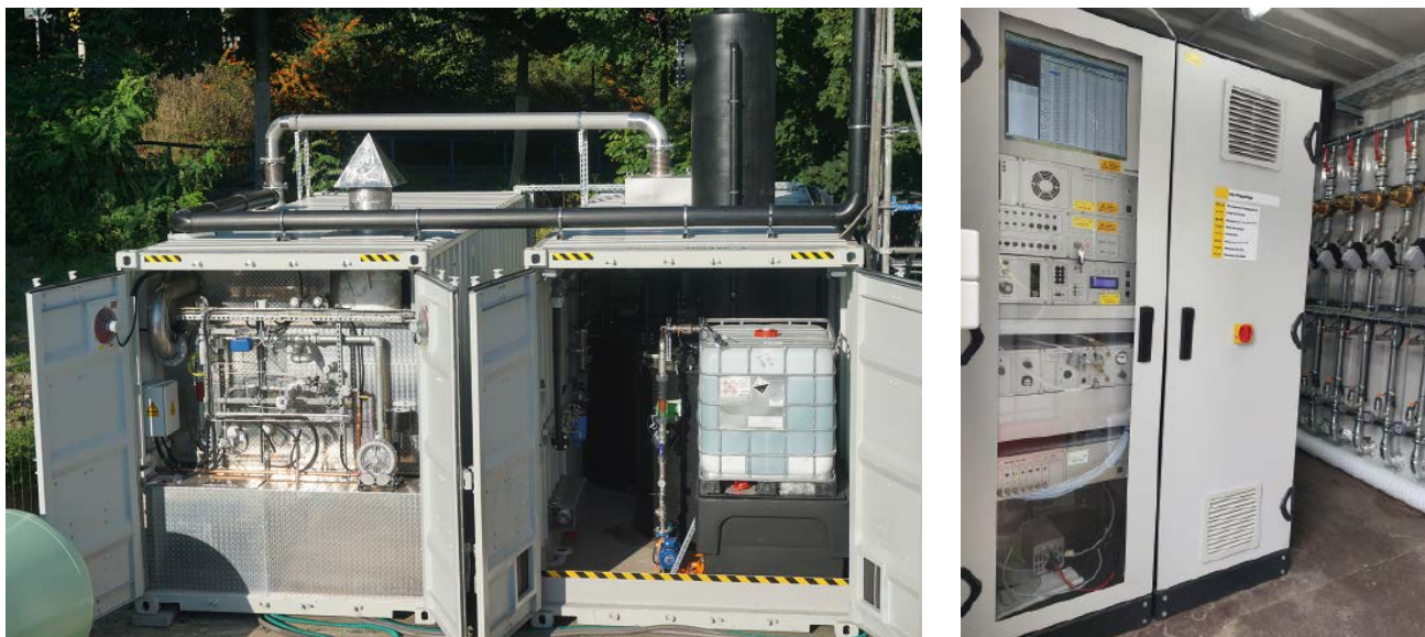
Abb. 12: Abluftbehandlung mittels KATOX/Quenche/Wäscher (links), Gaschromatograph zur Roh- und Reingasmessung (rechts)
