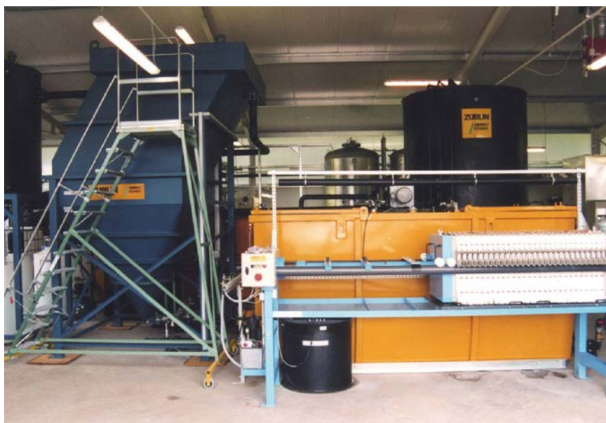
Abb. 7: Grundwasserreinigungsanlage zur Abstromsicherung, Fällung-Flockung-Sedimentation zur Abtrennung von Störstoffen (links); Strippanlage mit Abluftbehandlung, katalytische Nachverbrennung (rechts)
