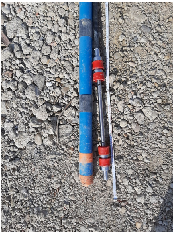
Abb. 9: Manschettenrohr und Packer zur tiefendifferenzierten Injektion von Reagenzien
